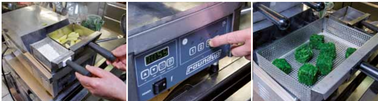
Verschiedene elektronisch gespeicherte Programme und verschiedene Gefässe machen den Roundup Deluxe Variety Mini-Steamer der Firma Plüss & Partners zu einem unverzichtbaren Gerät in der Küche des Gasthofs Krone Forch.
